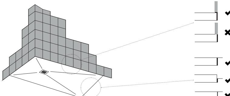
**ES** Proteja el plato de ducha y finalice la instalación de la mampara, alicateado etc. Es imprescindible dejar una junta rellena con masilla de poliuretano de 2-3 mm entre el plato de ducha y las paredes, azulejos, paneles de revestimiento o cualquier otro elemento colindante. En caso de colocar azulejo sobre el plato asegúrese de que su peso no descansa directamente sobre el plato de ducha.
