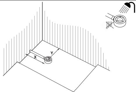
**ES** Instale la válvula coincidiendo con el centro del desagüe del plato de ducha. Asegúrese, vertiendo agua sobre el sifón, que no existen pérdidas en la conexión con el tubo.
