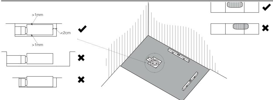
**ES** Genera con ayuda de un material rígido (cemento, ladrillo, azulejo...) una **base maciza no deformable y totalmente nivelada**. Asegúrese de que el hueco alrededor de la válvula no supera los 2 cm y de que ésta quede por debajo del nivel de la base.
